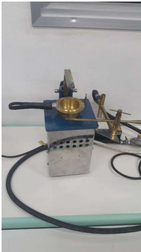
Figura 9 - ITEM 8 Aparelho de ponto de fulgor Cleveland tipo vaso aberto
