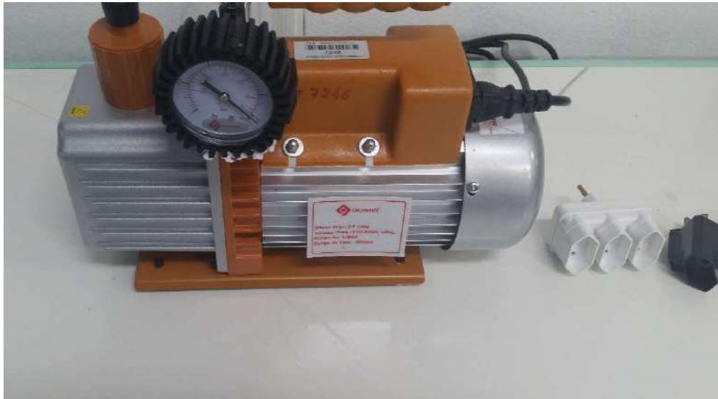
Figura 3 - ITEM 3 Bomba de vácuo
