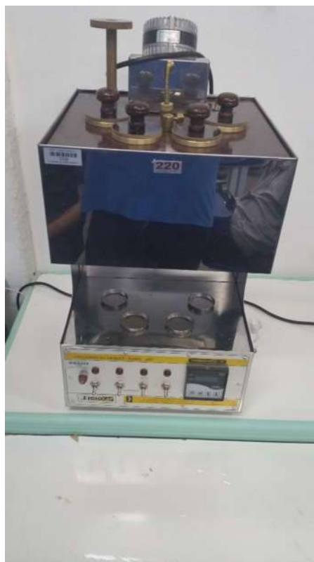
Figura 10 - ITEM 8 Viscosímetro Saybolt
