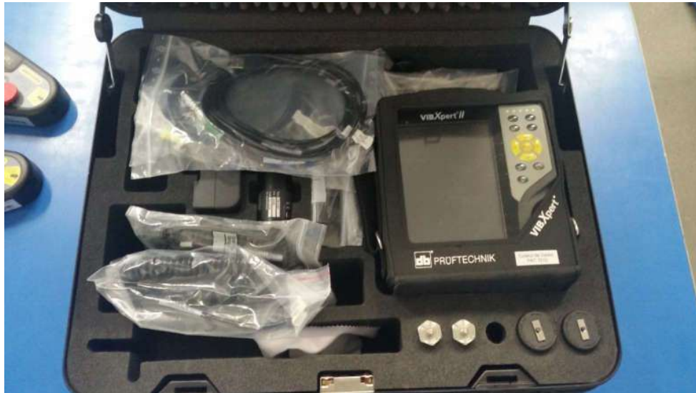
Figura 11 - ITEM 9 Coletor de dados para análise vibracional com balanceador dinâmico de máquinas
