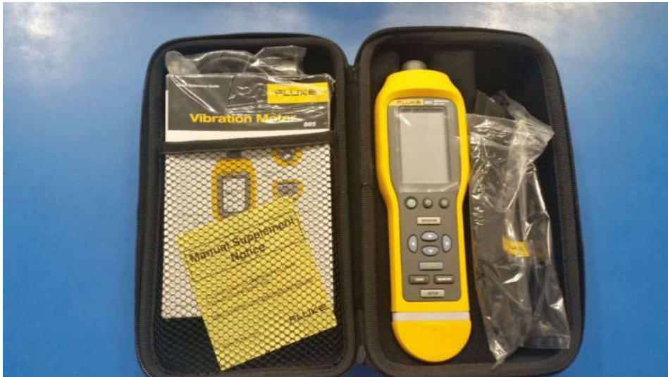
Figura 13 - ITEM 10 Medidor de vibração global portátil
