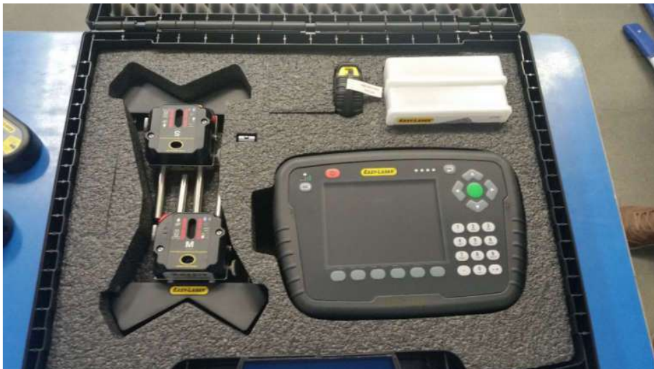
Figura 14 - ITEM 11 Sistema portátil de alinhamento de eixos a laser
