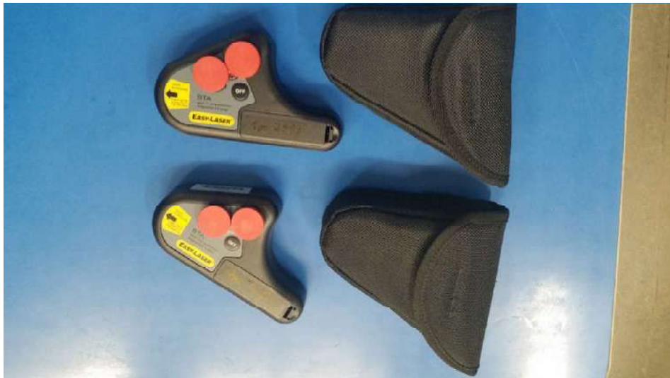
Figura 15 - ITEM 11 Sistema portátil de alinhamento de polias a laser
